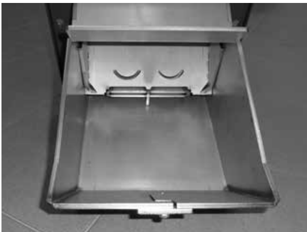
Joonis 3. - Põlemiskamber puhastusdüüsidega ning avadega, mille taha on paigaldatud süütespiraalid
