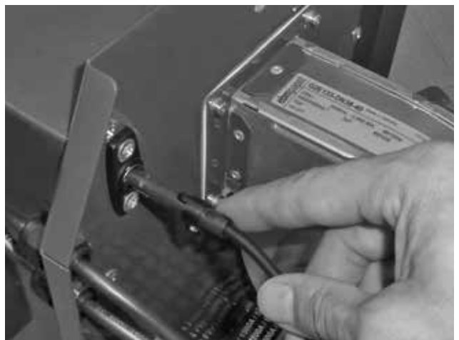
Joonis 6. Fotoelement – pöörake tähelepanu õigele paigutussuunale – soovitatav on puhastada vähemalt kord aastas
