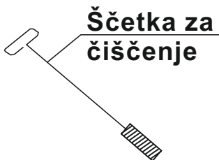
Slika 6. Oprema za čiščenje kotla BIO-PEK B
