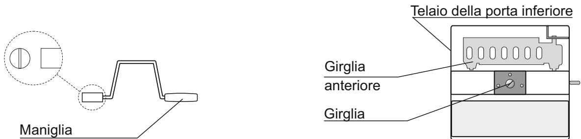
Foto 9. Griglia e strumento per alzare la griglia
